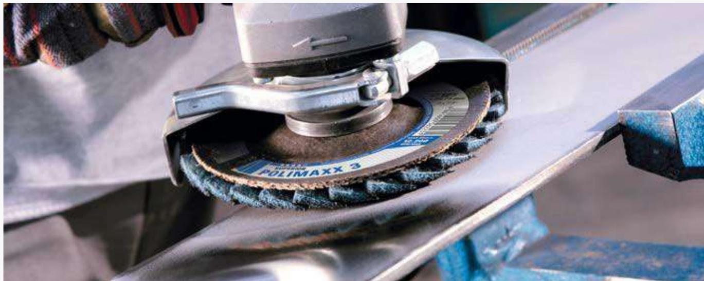
I dischi lamellari di lucidatura Osborn offrono risultati eccezionali per la lavorazione di acciaio inossidabile, acciaio, alluminio e metalli non ferrosi grazie a un innovativo ed efficace vello di smerigliatura disposto in una struttura a ventaglio a lamelle.
